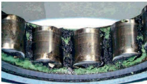
Degradação do lubrificante causada por descargas elétricas
