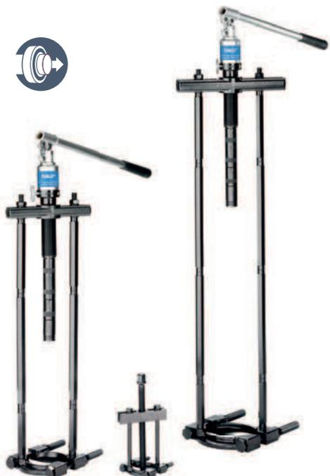
Os poderosos retroextratores SKF TMBS E facilitam a desmontagem de rolamentos nas aplicações, nas quais o emprego de extratores de garra tradicionais é restrito, devido à falta de espaço ou nas quais a aplicação exige uma extensão mais longa.
