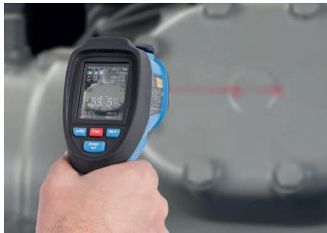
Quando usado no modo sem contato, o termômetro capta a energia térmica radiada por um objeto através de um detector infravermelho. Quando apontado para um objeto, o detector infravermelho coleta energia, produzindo um sinal que o microprocessador traduz como leitura no display com iluminação de fundo. Quando o gatilho é apertado, a temperatura do objeto é medida continuamente pelo detector infravermelho. Isso permite leituras rápidas e precisas, em tempo real.
