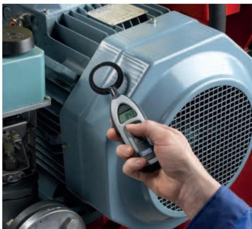
Os rolamentos dos motores elétricos acionados por controles de frequência variável ("Variable Frequency Drive", VFD) apresentam maior vulnerabilidade à erosão elétrica. Quando é incorporado ao programa de manutenção preditiva, a Caneta DDE pode ajudar a identificar os rolamentos mais suscetíveis à falha e evitar de modo significativo as interrupções não planejadas de funcionamento das máquinas.
