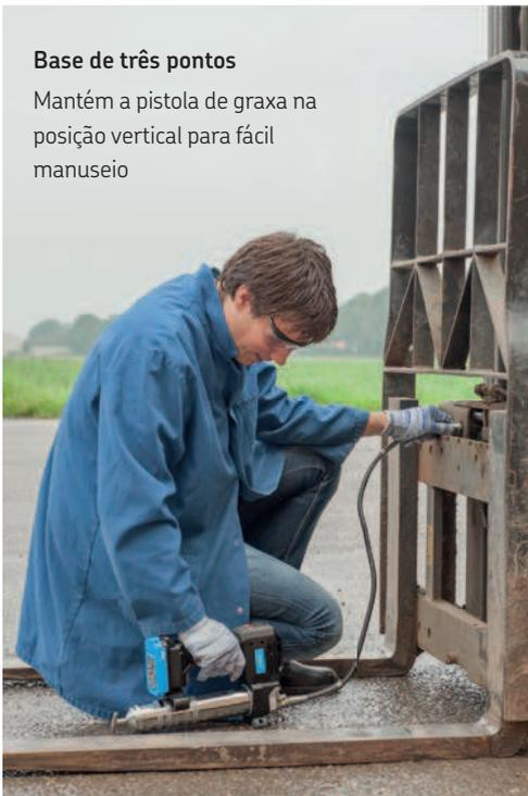
O display da ferramenta indica o nível de carga da bateria, a quantidade de graxa aplicada, a velocidade da bomba/motor e pontos de lubrificação bloqueados. Esta pistola de graxa versátil oferece duas taxas de fluxo – alta e baixa – e pode aplicar até 15 cartuchos de graxa por carga de bateria. A pistola TLGB 20 consegue fornecer pressões de até 700 bar (10 000 psi) e possui uma luz interna para iluminar a área de trabalho.
