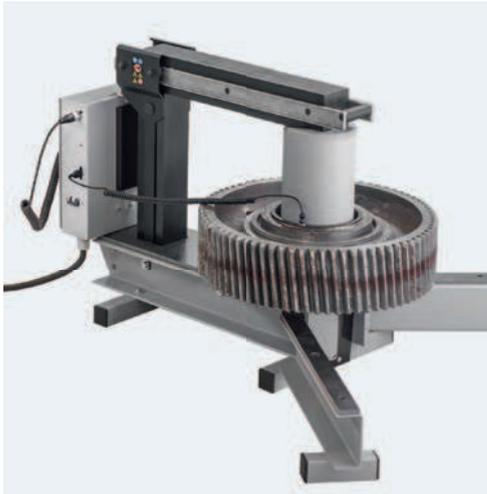
O aquecedor TIH L MB aquece peças que não sejam de rolamentos de até 600 kg (1 323 lb) conforme o modelo
