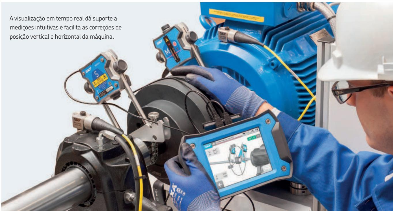
O avançado sistema de alinhamento a laser com capacidades de medição e relatório aprimoradas
