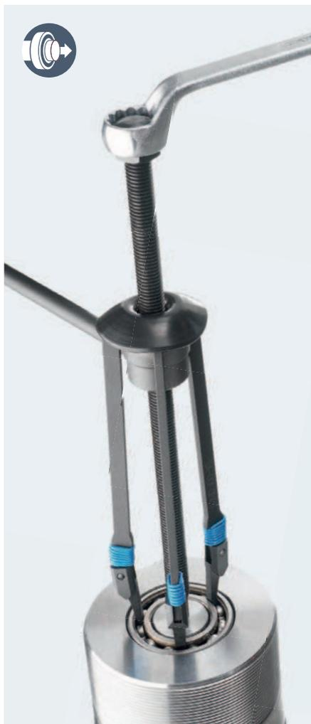
Projeto otimizado de garra do extrator agarra firmemente a pista externa dos rolamentos SKF, sem a necessidade de remover a gaiola do rolamento.
