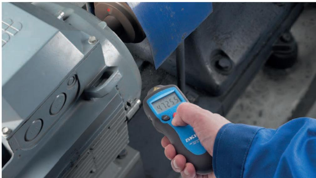
O sistema ótico a laser permite medições fáceis e rápidas a uma distância segura da máquina rotativa
