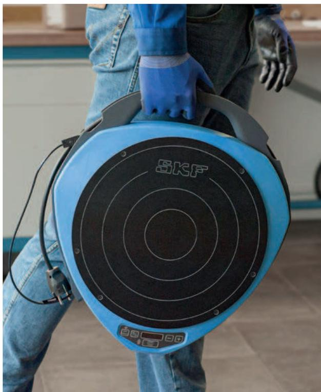
Por utilizar energia elétrica, o TWIM 15 tem uma construção plástica de fibra de vidro resistente a altas temperaturas que permite uma diferença baixa de temperatura entre os anéis interno e externo do rolamento. Isso ajuda a reduzir as tensões internas que são geradas devido ao excesso de expansão térmica do anel interno em comparação ao anel externo.
