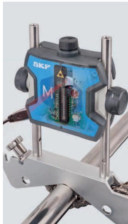
A visualização em tempo real dá suporte a medições intuitivas e facilita as correções de posição vertical e horizontal da máquina.
