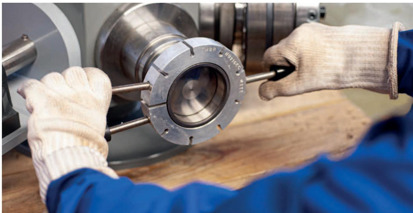
A série TMBR de anéis de aquecimento de alumínio SKF é produzida com precisão para encaixar um anel do rolamento específico. As listas com os detalhes para o pedido facilitam encontrar o TMBR certo para uma determinada designação do rolamento.
